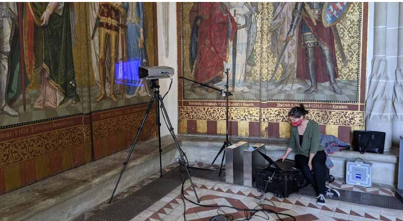
Hochauflösender 3D-Scan des Tafelgemäldes von Lucas Cranach dem Jüngeren in der Schlosskirche von Augustusburg zum Zwecke der Bestandsdokumentation.
