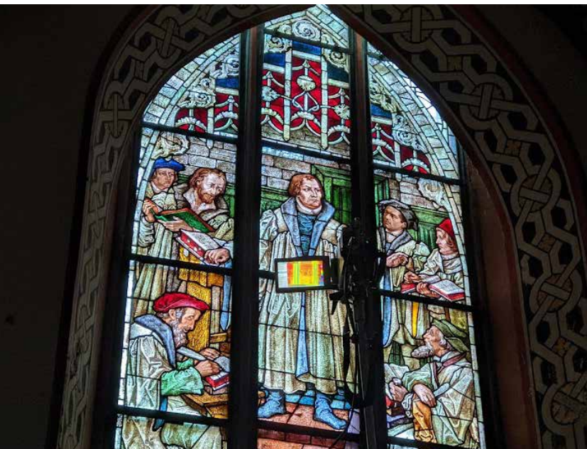
Durchführung der Thermografie am Beispiel eines Kirchenfensters
