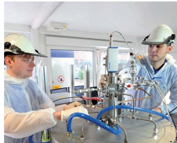
Laborversuche zur energieeffizienten Gewinnung von Rohsilizium im Mikrowellenofen
